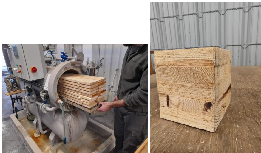
Introducción de muestras en el autoclave. Muestra tras ensayo de delaminación.
